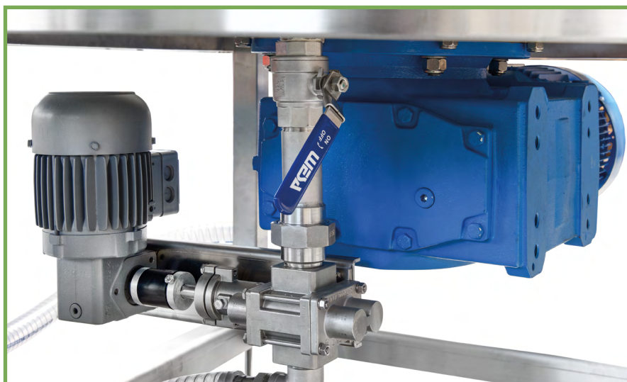
Spust awaryjny w dolnej części fermentatora do prostszego opróżniania z ciasta lub wody myjącej.
